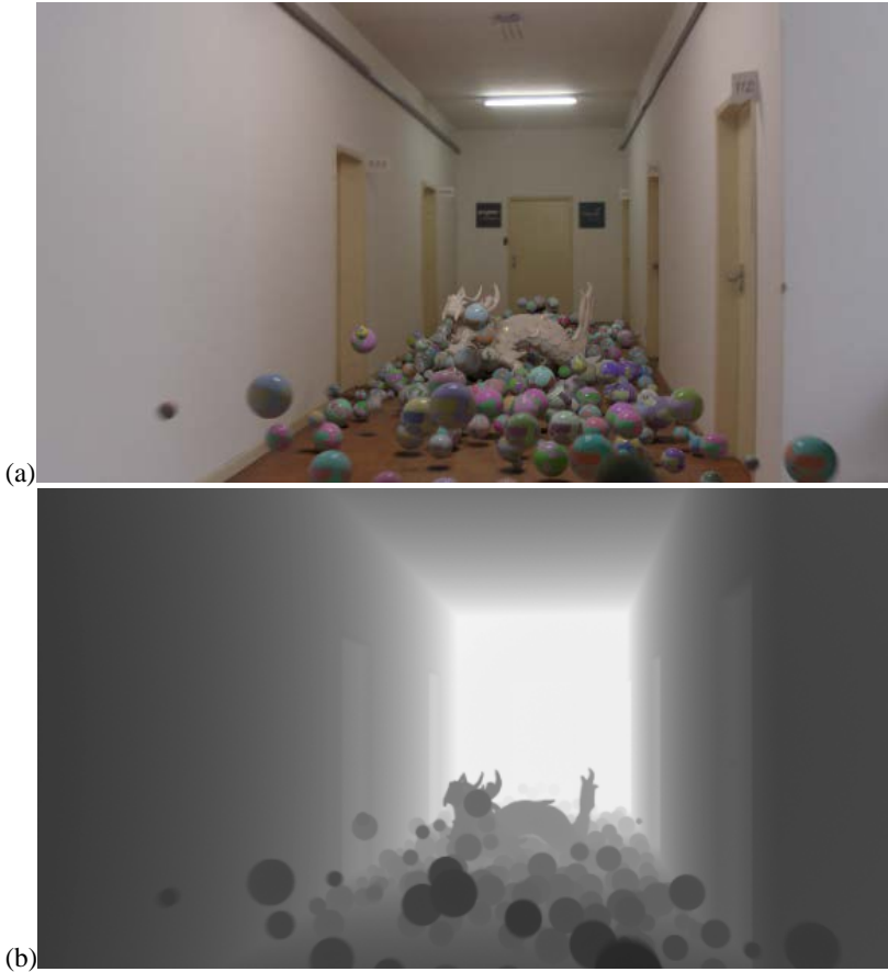
Figura 20 - (a) Render colorido do ambiente virtual criado para os testes. (b) Mapa de profundidade do ambiente virtual, as cores escuras representam pontos próximos da câmera, pontos claros representam pontos distantes da câmera.
