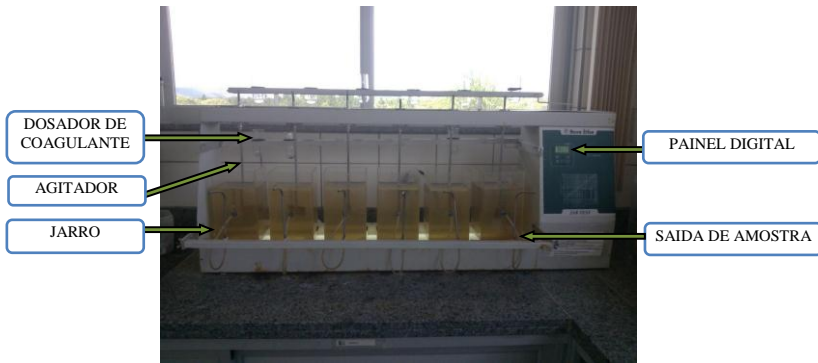
Figura 13. Equipamento Jar Test para realização dos ensaios de coagulação, floculação, sedimentação.
