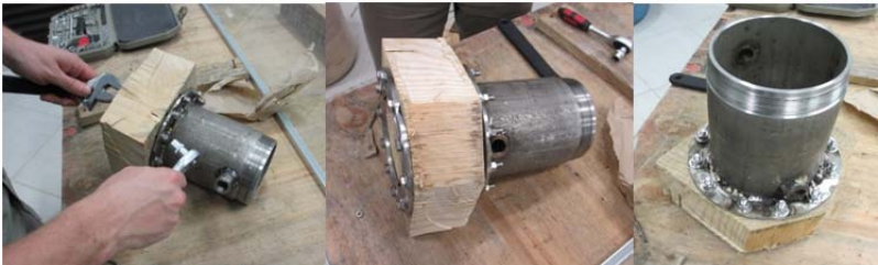
Figura 26 – Construção do filtro piloto para filtração tangencial helicoidal
