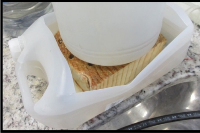
Figura 14 – Desinfecção da madeira com hipoclorito de sódio
