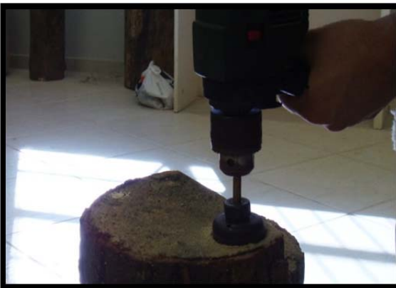
Figura 20 – Corte dos elementos filtrantes para filtração frontal
