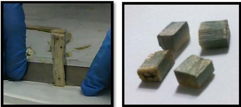
Figura 34 - Amostras das madeiras após corte e cobrimento de ouro
