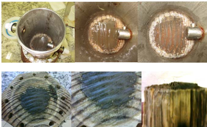
Figura 37 – Desmontagem do filtro piloto e elemento filtrante colmatado
