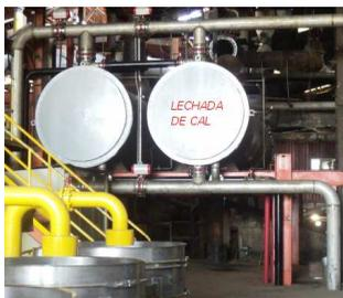
Fig. 2.3: sistema de alcalinização
