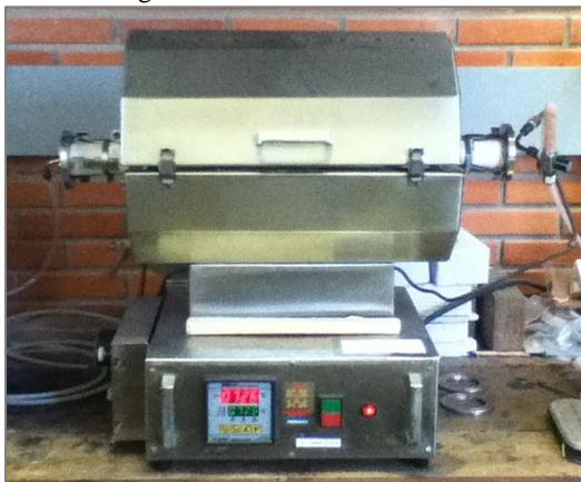
Foram selecionadas para o tratamento térmico as temperaturas de 550°C, 580°C, 600°C, 680°C e 700°C, sendo elas realizadas sob atmosfera inerte ( $N_2$ ). A seleção das temperaturas foi realizada visando a melhor eliminação de enxofre das amostras, uma vez que este fenômeno se inicia nessa faixa de temperatura. A taxa de aquecimento utilizada foi de 10°C/min e tempo de patamar de uma hora para todas as temperaturas. As reações foram feitas nas instalações do Senai/CTCMAT de Criciúma.
