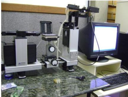
**Figura 8.1:** Goniômetro (OCA-20, Dataphysics) para determinação do ângulo de contato.
