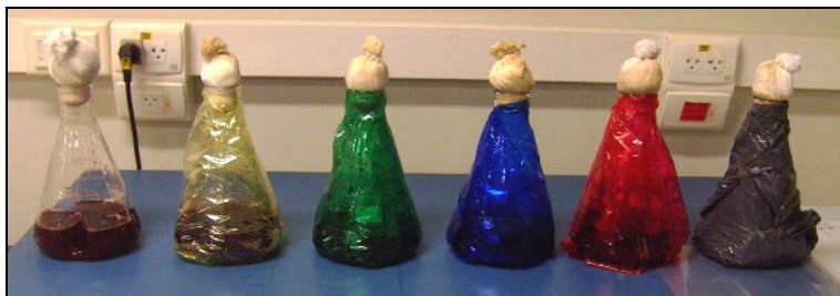
FIGURA 4.30 – Frascos aletados cobertos com filme colorido. Da esquerda para a direita: frasco sem filme (iluminação direta), filme amarelo, filme verde, filme azul, filme vermelho e filme preto.
