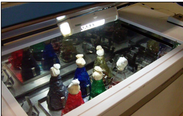
FIGURA 4.29 – Cultivo submerso de Monascus ruber em frascos aletados cobertos com filme colorido e expostos à fonte de iluminação contínua.
