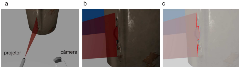
Figura 18: Sistema de triangulação ativa por plano laser
