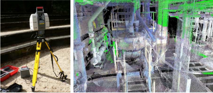
Figura 33: Scanner LIDAR (Esquerda) / Modelo gerado com sistema LIDAR (Direita) (LEICA, 2009)
