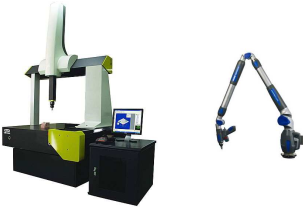
Figura 5: Máquina de medição por coordenadas (Esquerda) e Apalpador manual (Direita) (LEADER, 2009)
