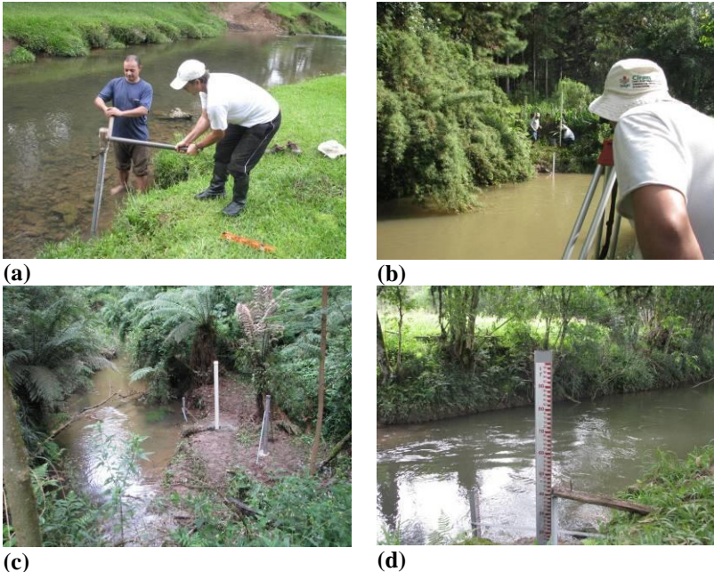
Figura 5.8 - Instalação das réguas (a) Fixação da primeira régua no leito do rio do ponto RB05; (b) Nivelamento das réguas com um nível topográfico no ponto RB06; (c) e (d) Estações fluviométricas instaladas nos pontos RB11 e RB04, respectivamente
