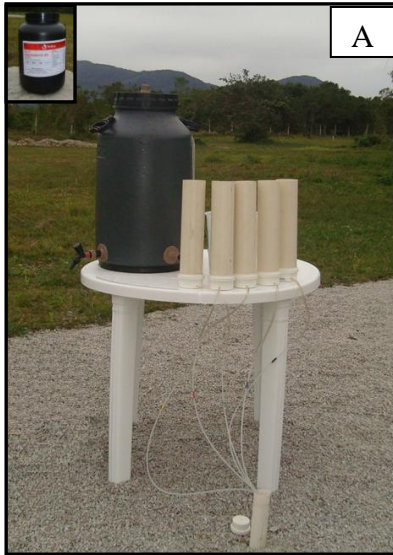
FIGURA 6.6. (A) Sistema de injeção de acetato de amônio com tubos de PVC contendo 1L da solução de acetato de amônio, previamente preparada no barrilete e conectada às mangueiras diferenciadas por cores e correspondentes aos diferentes níveis de profundidade. (B) Localização dos poços de injeção e da fonte de contaminação.
