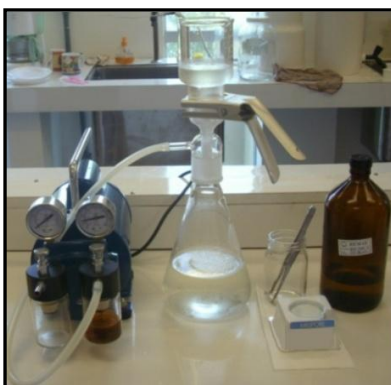
FIGURA 6.9. Sistema de filtração a vácuo para amostras de água subterrânea.
