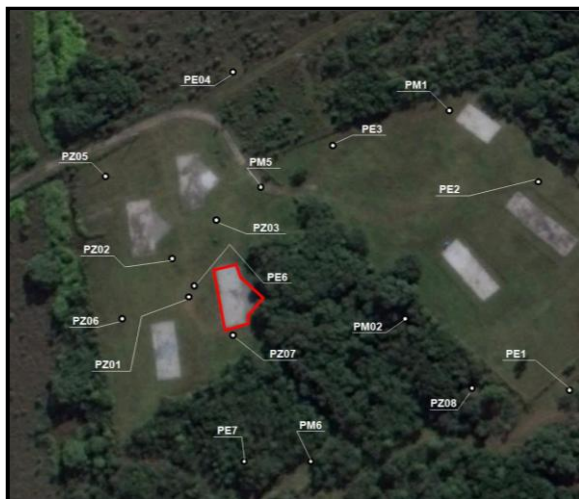
FIGURA 7.1. Localização da área experimental (em vermelho) e piezômetros (em branco) utilizados para as medições do nível do lençol freático e para avaliar a direção do fluxo.
