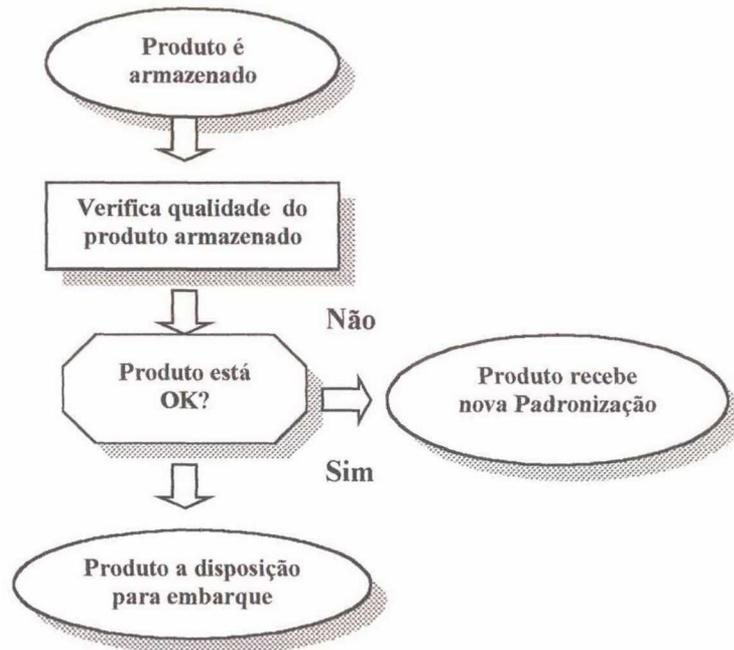
Figura 10 – Procedimentos no armazenamento dos grãos
