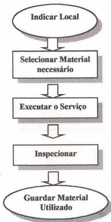
Figura 12 – Procedimentos na limpeza de armazéns, silos e moegas
