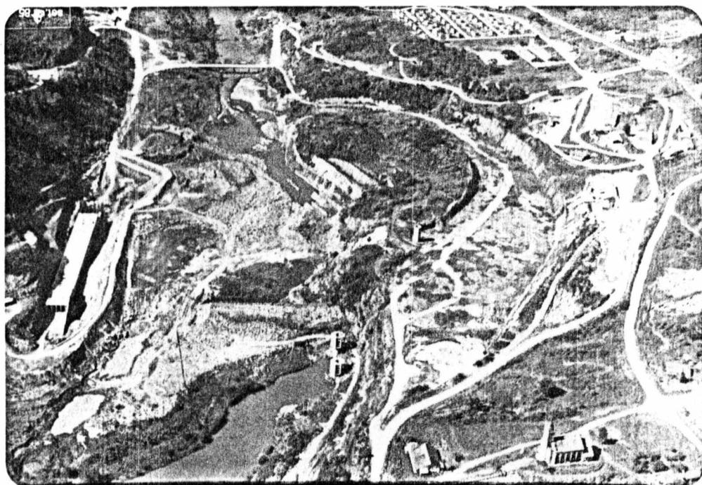
17. Vista aérea da Barragem Norte. Em primeiro plano, vê-se as entradas dos túneis e as "tulipas"; à esquerda, a estrutura de escoamento de emergência nas cheias (esta estrutura será soterrada e inutilizada pela barragem); à direita, o vertedouro da barragem. Em último plano, a ponte de acesso à nova Sede do Posto indígena (distante sete quilômetros dali). Julho-1985.
