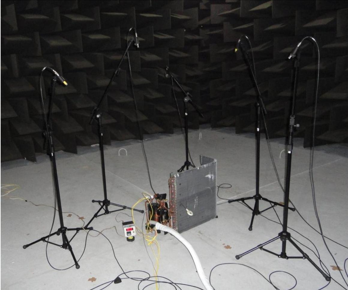
Figura 9 – Microfones posicionados para medição
