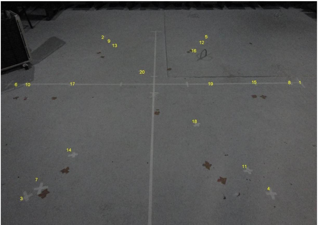
Figura 8 – Marcação das posições dos microfones na câmara semi-aneecóica
