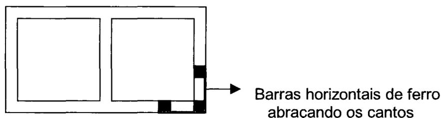
Figura 4 – Na vista superior das cisternas, a representação esquemática das barras que abraçam os quatro cantos de cada cisterna.
