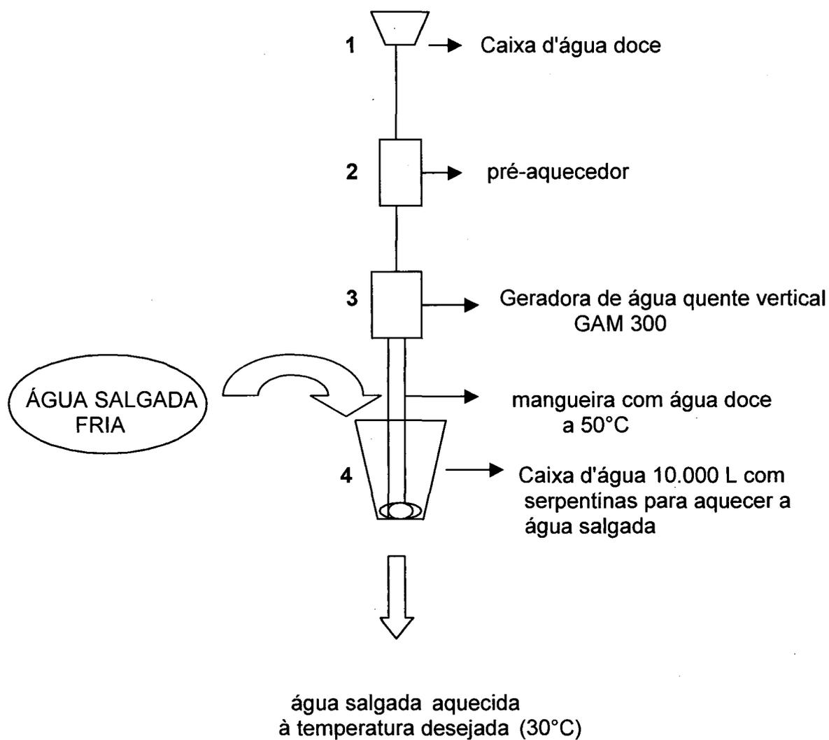
Figura 5 – Esquema básico do sistema de aquecimento de água geral
