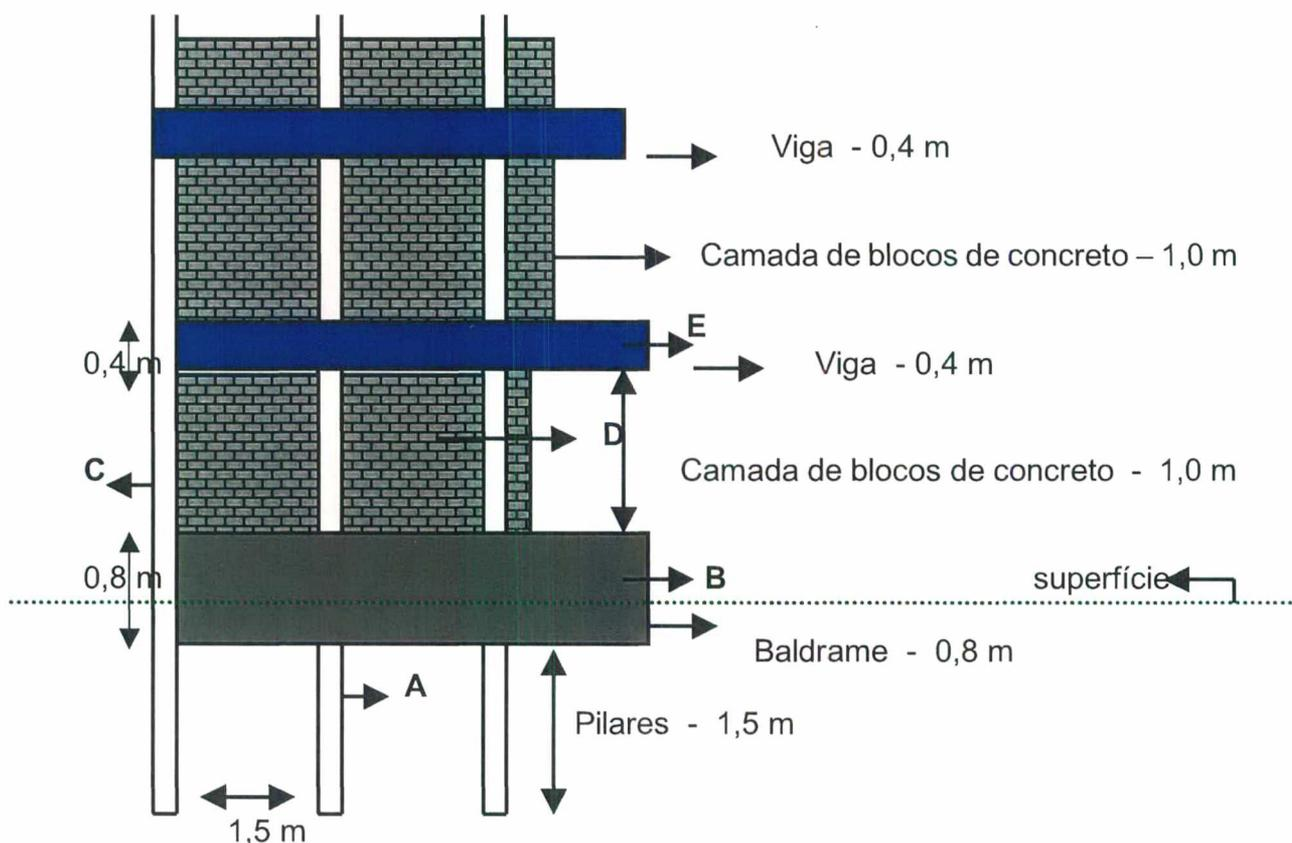
Figura 2 – Esquema básico de representação da construção das cisternas.
