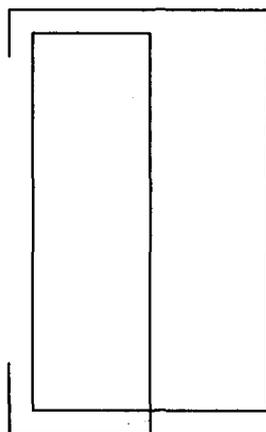
Figura 3 – Representação esquemática do estrivo constituído de uma barra de ferro inteira dobrada, para dar maior resistência.
