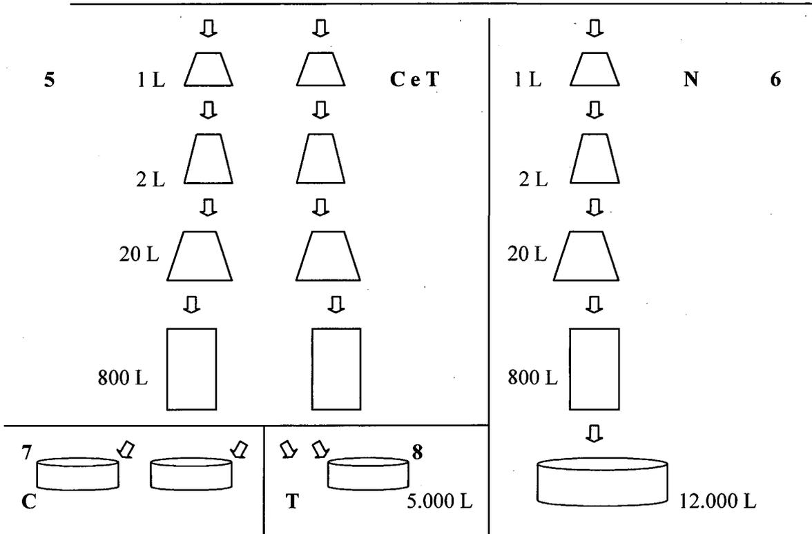
Figura 8 – Esquema básico sugerido para produção de microalgas.
