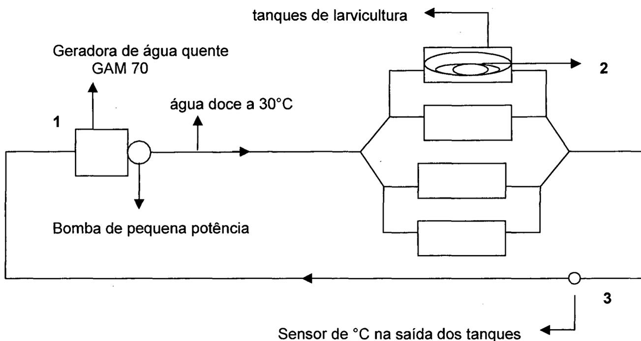
Figura 6 – Esquema básico de funcionamento do sistema de manutenção da temperatura nos tanques de larvicultura.
