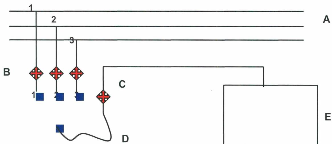
Figura 7 – Representação esquemática dos três sistemas de distribuição de água disponíveis em cada sala.
