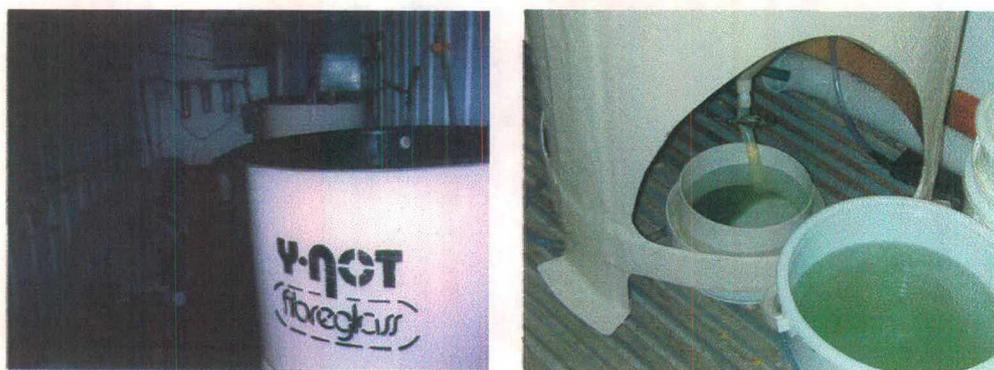
Figura 9 - Incubadora do tipo cilindro-cônico.
