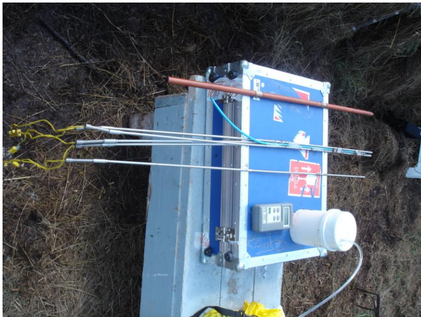
Foto 7: Ao centro, hastes do termômetro utilizadas para medição. Na parte inferior está a base móvel do termômetro
