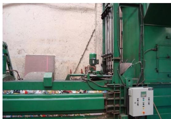
Figura 22 – Máquina responsável pela trituração, processo de enfardamento do papel.
