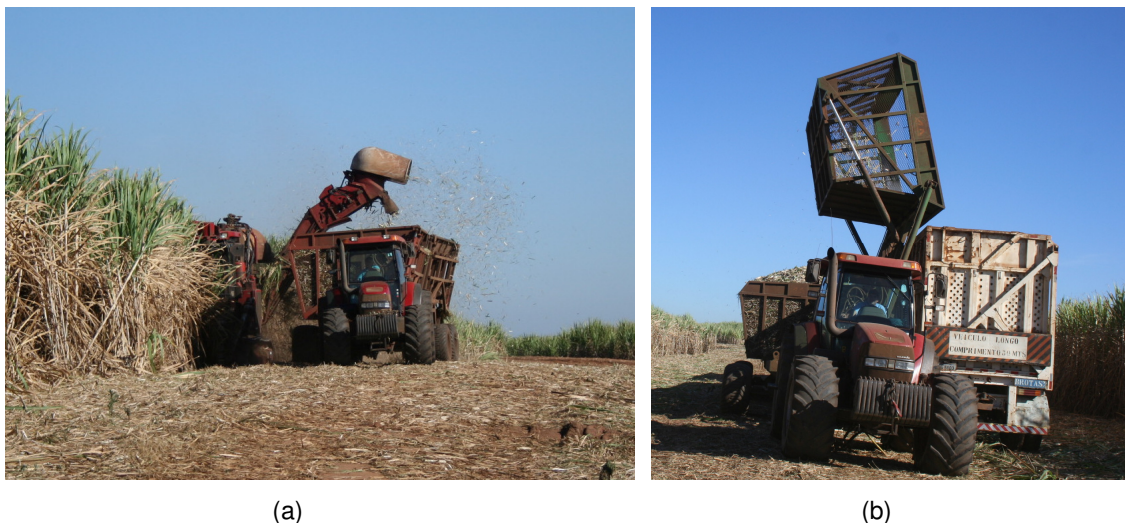
(a) (b) Figura 1 – Colhedora autopropelida em processo de colheita e trator com o trasbordo (a). Transbordo efetuado em espaço reservado para manobras de veículos, malhador (b). (Fonte: Agroconsult)
