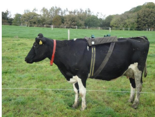
Figura 2 - Vaca Holandês do grupo de baixa lotação com a mochila de sustentação dos cilindros de coleta de \text{CH}_4 e \text{SF}_6
