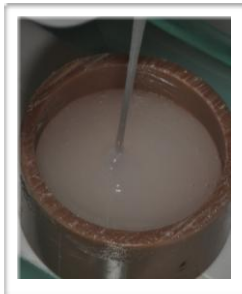
Fig.9-10 - Inclusão dos espécimes em resina epóxica.
