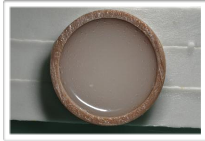
Fig.9-10 - Inclusão dos espécimes em resina epóxica.
