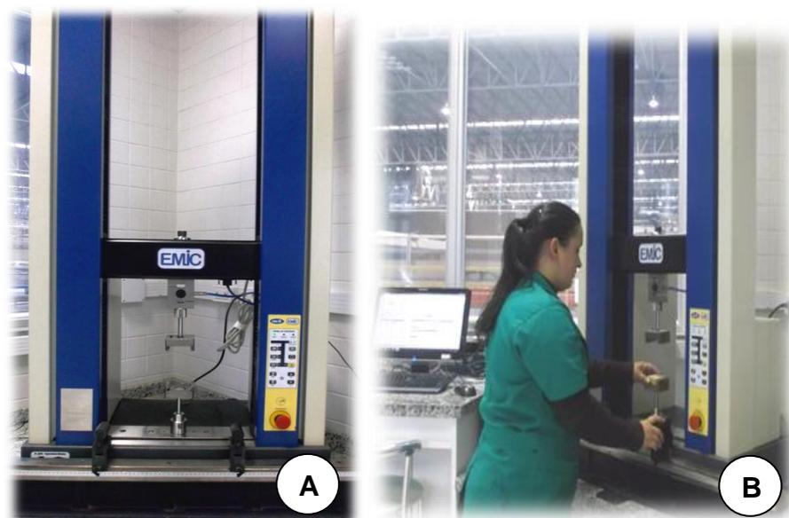
Figura 29 - (A) equipamento de ensaio universal e (B) realização de um teste de tração perpendicular. (Fonte: Jaqueline da Silva Batista).
