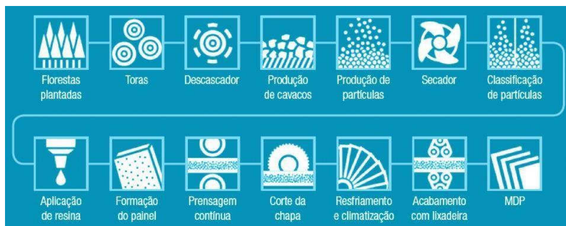
Figura 2: Fluxograma ilustrativo do processo produtivo de painéis aglomerado.
