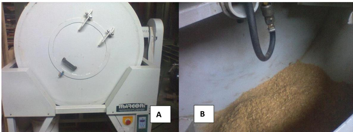
Figura 11. A)Tambor do tipo rotatório B) partículas colocados no tambor. *Fonte: O Autor (2014)*
