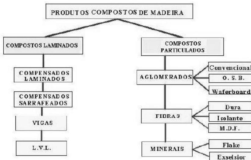
Figura 3. Esquema representativo dos painéis de madeira. *Fonte: Iwakiri et al., 2005.*
