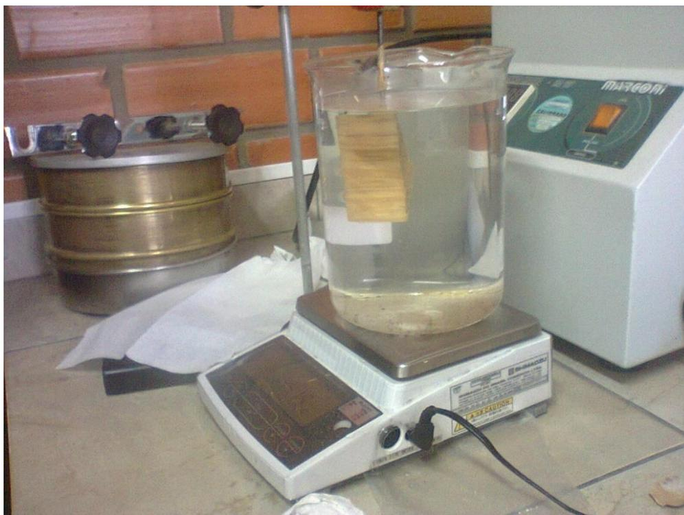
Figura 9. Determinação do volume da madeira através de uma balança hidrostática. Fonte: O Autor (2014)
