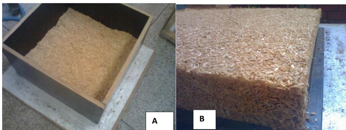
Figura 12. A) Caixa formadora com dimensões de 40 cm x 40 cm de comprimento B) colchão de partículas após a etapa de pré-prensagem. *Fonte: O Autor (2014)*
