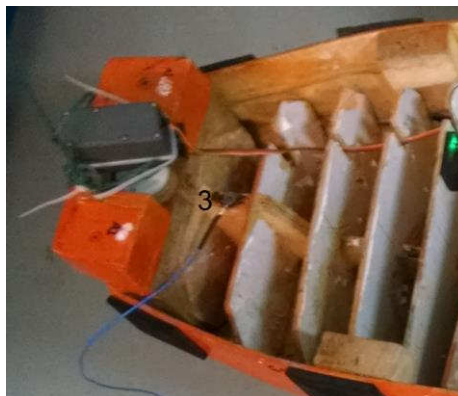
Figura 21: Acelerômetro fixado no ponto de referência.
