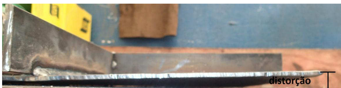
Figura 31: Ilustração da distorção para a medição dos experimentos
