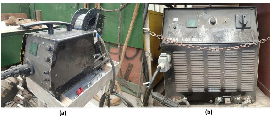
Figura 32: Alimentador de arame (a) e a fonte de soldagem (b)
