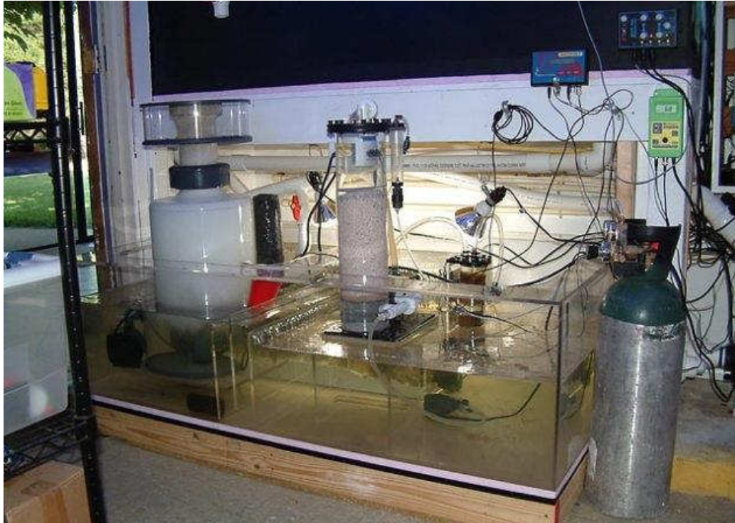
Figura 11 - Foto ilustrativa de um sump utilizado em um aquário doméstico
