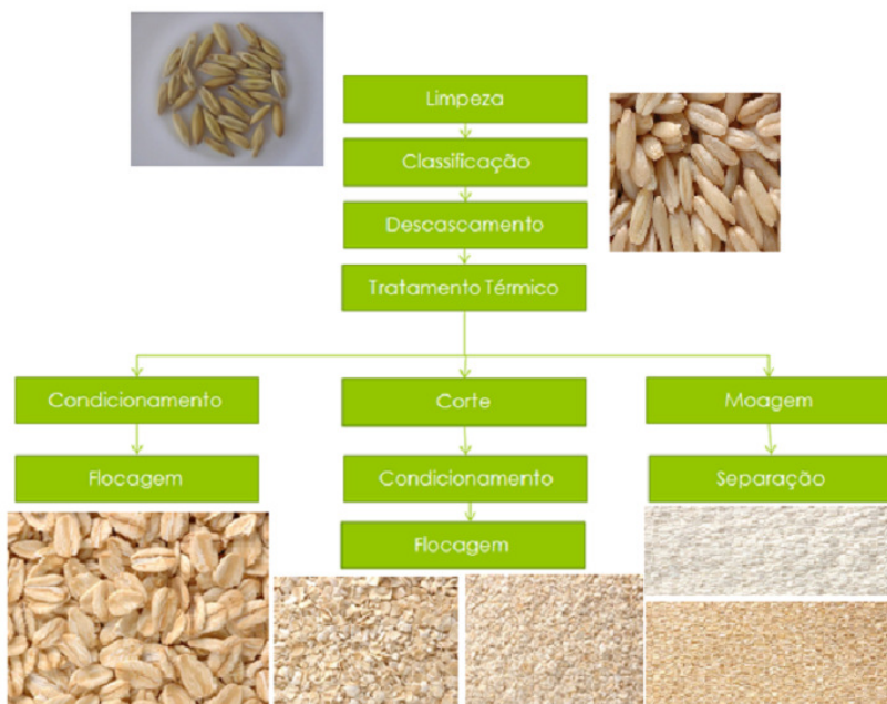
Figura 6 - Fluxograma do processo produtivo da aveia para a obtenção produtos.
