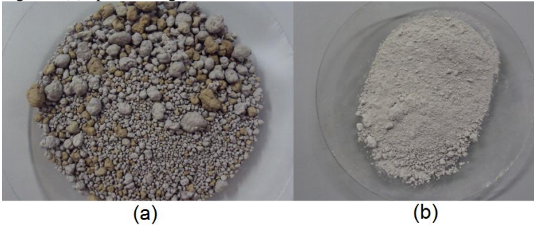
Figura 4.1 - Resíduo do processo de polpamento de papel branco, (a) antes da moagem e (b) após a moagem.
