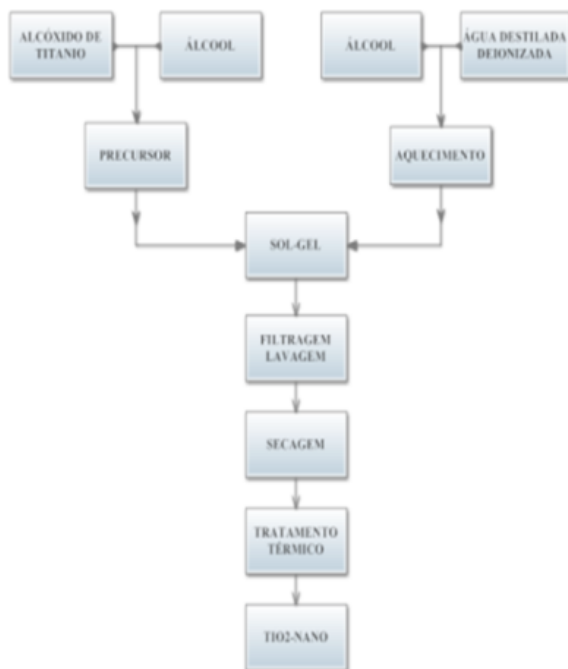
Figura 14 - Fluxograma das etapas do processo de Sínteses para obtenção do dióxido de titânio nanoestruturado.
