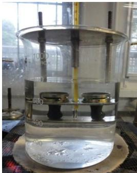
**Figura 5.2** – Esquema do ensaio de amolecimento ou anel e bola.
