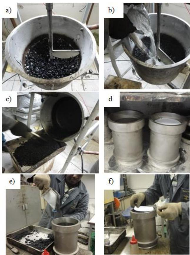
**Figura 5.12** – A sequência de elaboração da mistura e preparação para ensaio de PCG: (a) envolvimento dos granulares-ligantes asfálticos por meio do misturador; (b) adição de finos no envolvimento granulares-ligantes asfálticos; (c) colocação da mistura na bandeja a ser colocada na estufa; (d) moldes na estufa por um período de duas horas; (e) colocação da mistura no molde; e (f) preparação para compactação.
