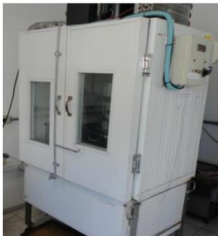
**Figura 5.18** – Máquina de Fadiga utilizada como câmara térmica de condicionamento no ensaio de Duriez.
