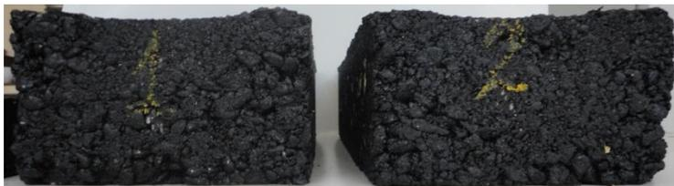
**Figura 6.13** – A seção transversal de afundamento do par de placas da mistura GB-4 após ensaio.
