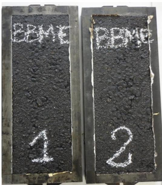
**Figura 6.11** – Par de placas BBME-2 após compactação para ensaio de Deformação Permanente.
