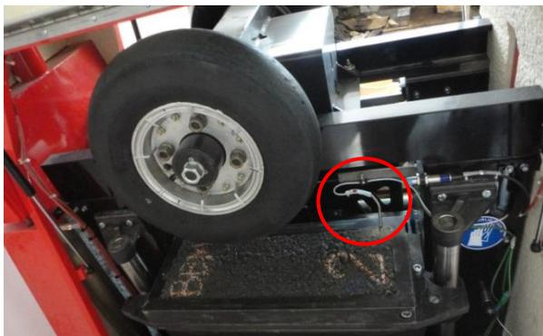
**Figura 5.28** – Sonda térmica de monitoramento da temperatura.
