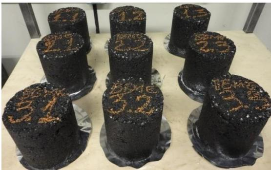
**Figura 6.7** – Corpos de provas da mistura *Béton Bitumineux Módulo Elevé* (BBME-2)
