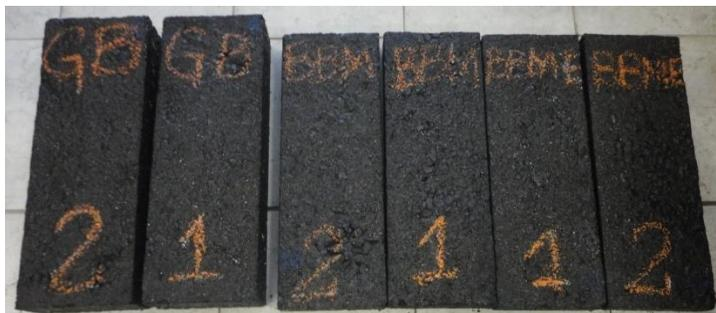
**Figura 5.25** – Placas para ensaio de Deformação Permanente em repouso.
