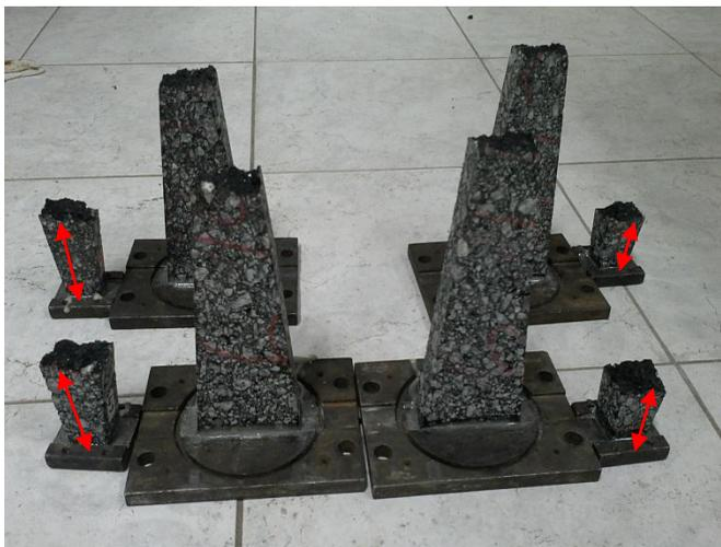
**Figura 5.43** – Zona de ruptura do corpo de prova.
