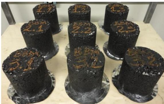
**Figura 6.4** – Corpos de provas da mistura *Béton Bitumineux Mince* (BBM-3)
