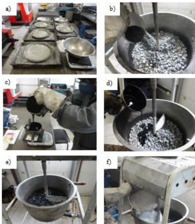
**Figura 5.21** – Preparação e usinagem das misturas asfálticas: (a) pesagem e separação dos materiais granulares em bandejas; (b) adição dos aditivos sobre os granulares no misturador na temperatura de mistura; (c) pesagem da quantidade certa do ligante asfáltico para a mistura; (d) colocação do ligante asfáltico sobre os granulares; (e) mistura por envolvimento granular graúdo e ligante asfáltico; e (f) adição dos materiais finos (*filler*) sobre as misturas.
