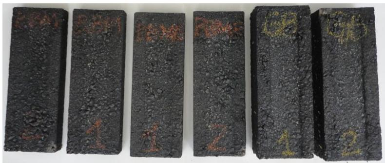
**Figura 6.12** – Apresentação dos resultados de afundamento das placas após ensaio.
