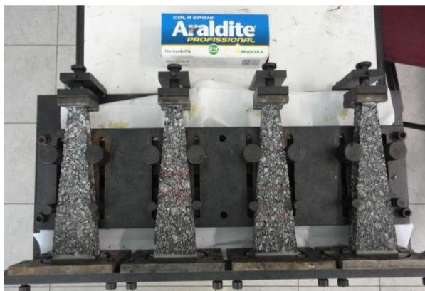
**Figura 5.39** – Mesa de colagem dos corpos de prova.
