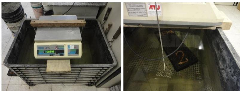
**Figura 5.26** – Pesagem hidrostática das placas para o ensaio de Deformação Permanente.
