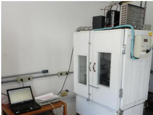
**Figura 5.38** – Máquina de execução dos ensaios de Módulo Complexo e de Fadiga.
