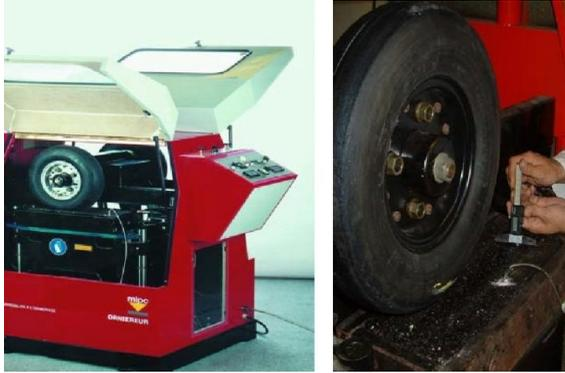
**Figura 3.8** – Equipamento de ensaio de deformação permanente e leitura da profundidade (LPC, 2007).
