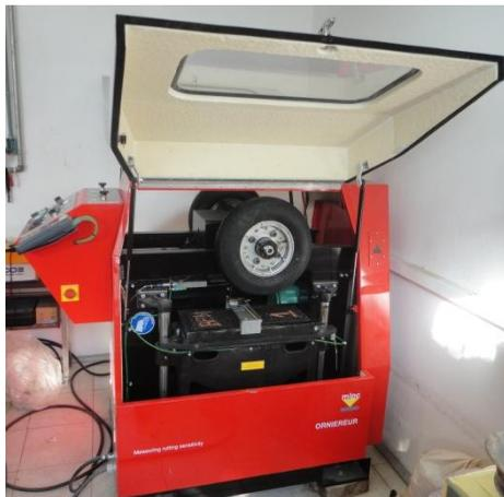
**Figura 5.27** – Equipamento do ensaio de Deformação Permanente.
