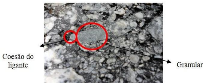
**Figura 2.2** – Mistura Asfáltica
