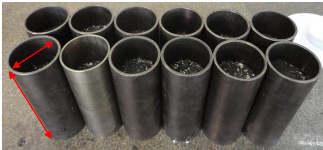
**Figura 5.14** – Moldes de aço utilizados no ensaio de Duriez
