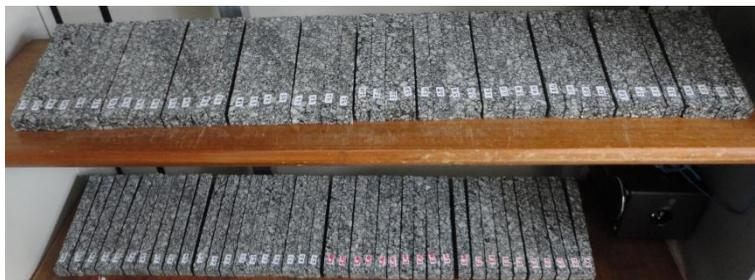
**Figura 5.37** – Conjunto de corpos de prova trapezoidal em repouso.
