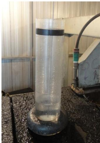
**Figura 5.45** – Ensaio de Drenabilidade.
