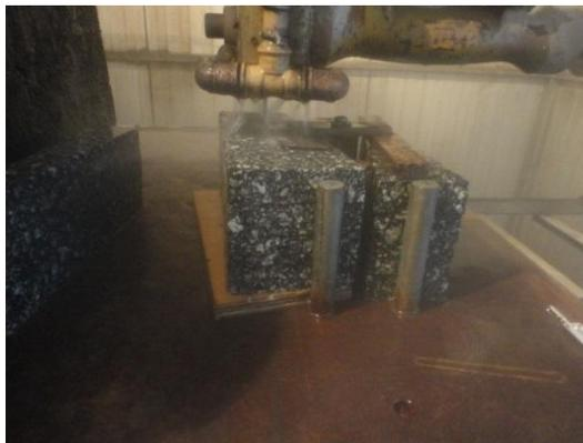
**Figura 5.35** – Corte das plaquetas dos corpos de prova trapezoidais.
