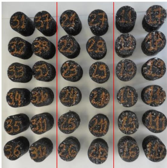
**Figura 6.10** – Corpos de prova das três misturas após a moldagem.
