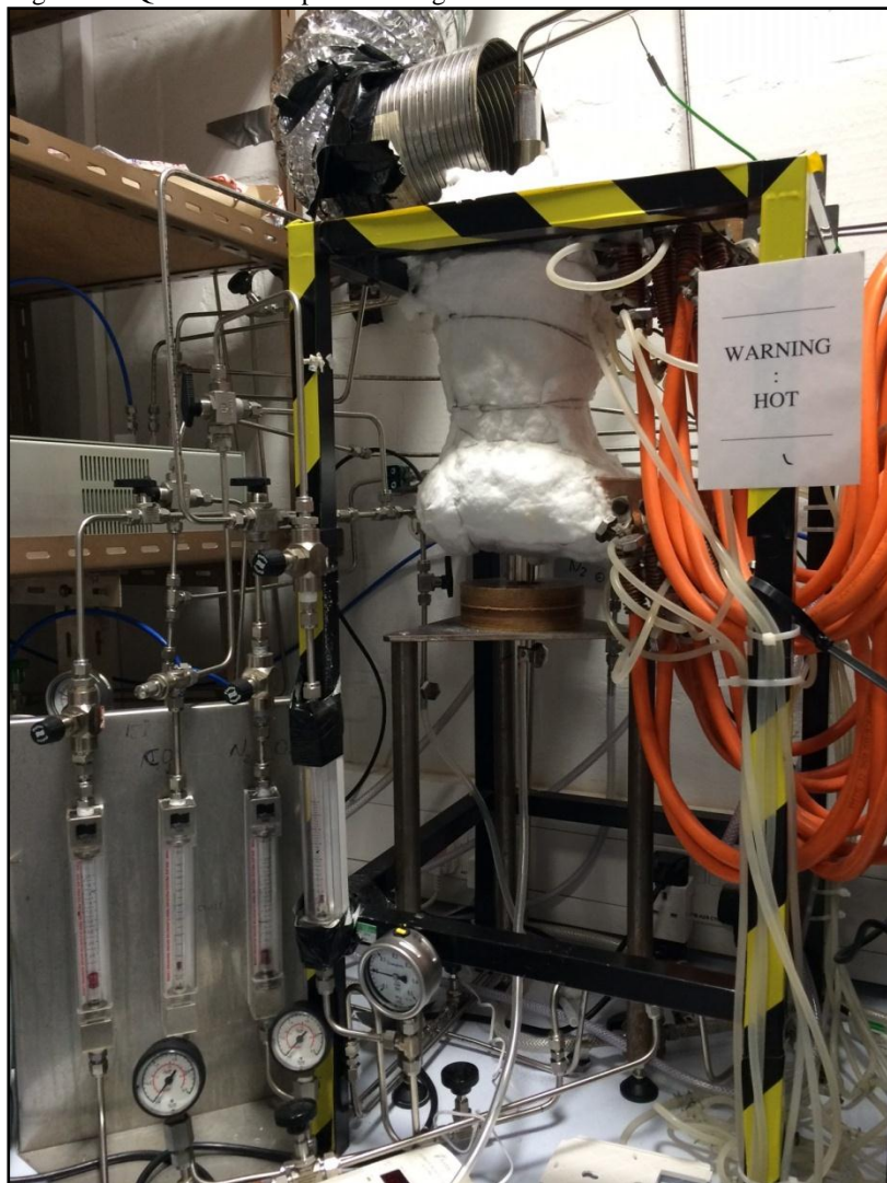
Figura 7.16 - Reator de leito fluidizado, no laboratório do Departamento de Engenharia Química do Imperial College London.
