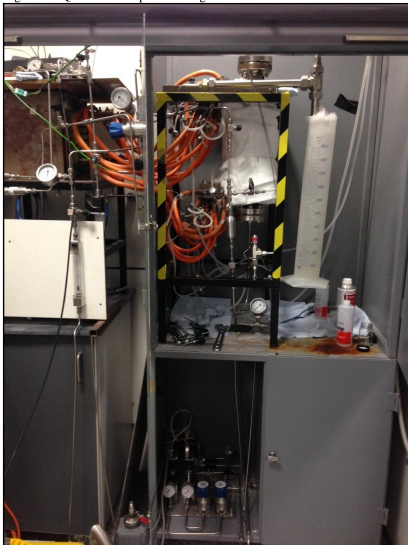
Figura 7.17 - Reator de leito de jorro, no laboratório do Departamento de Engenharia Química do Imperial College London.
