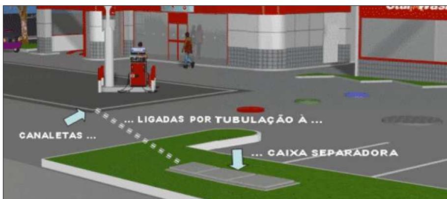
Figura 5. Canaleta de contenção em um posto de abastecimento (OLIVEIRA, 2008).
