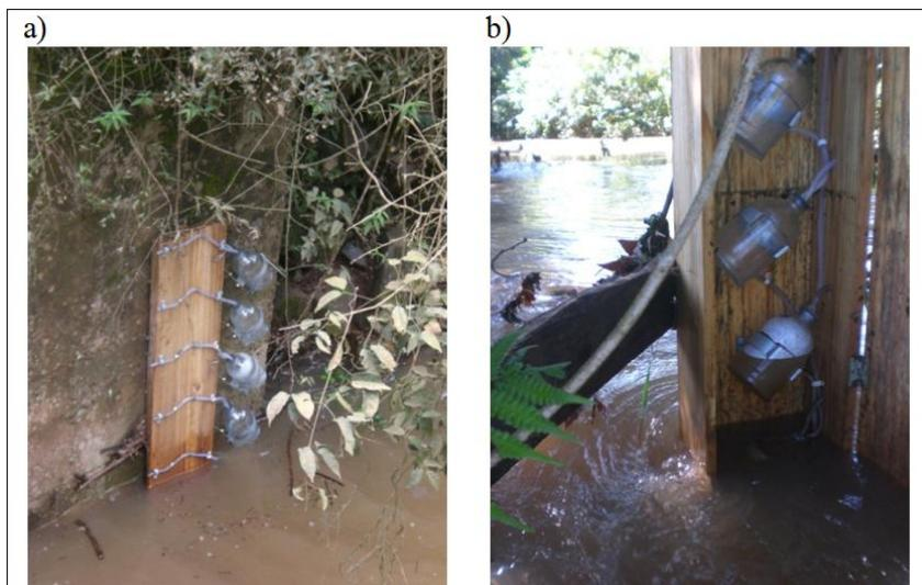
Figura 9 - Amostradores de nível ascendente na seção central (a) e na seção jusante (b).
