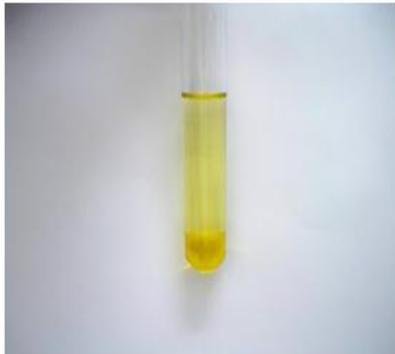
Figura 23 b. Extrato de maracujá obtido por extração com  $\text{CO}_2$  supercrítico e co-solvente etanol, coleta dividida em dois frascos.
