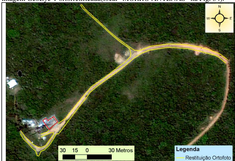
Figura 36: Comparação entre restituição parcial criada a partir da ortofoto e imagem GeoEye-1 ortorretificada (local “MORRO ANTENAS” na Fig. 34).
