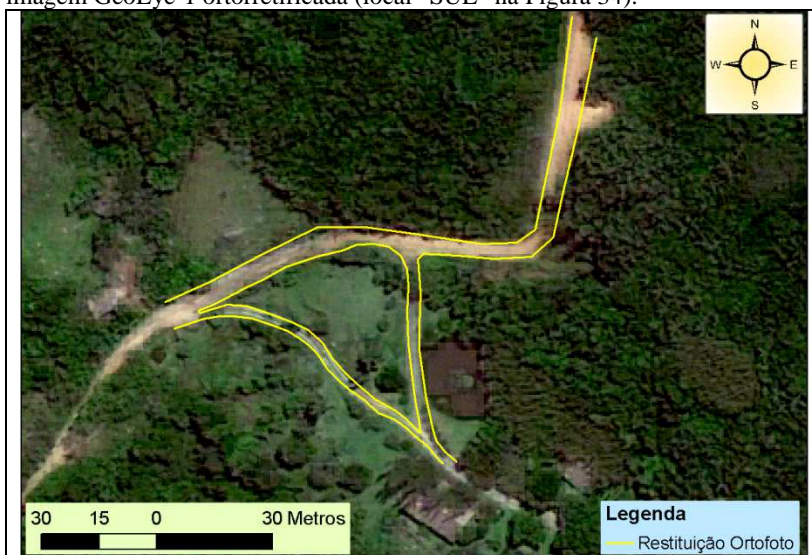
Figura 35: Comparação entre restituição parcial criada a partir da ortofoto e imagem GeoEye-1 ortorretificada (local “SUL” na Figura 34).
