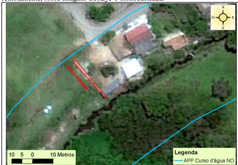
Figura 61: Detalhe do muro em APP de curso d'água, medido a campo e remotamente, sobre imagem GeoEye-1 ortorretificada.
