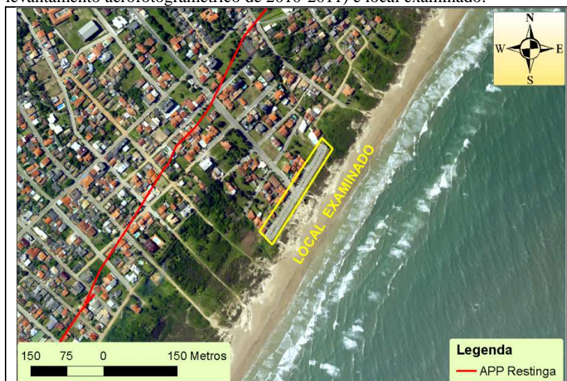
Figura 42: APP de Restinga (delimitada em SIG sobre ortofoto oriunda do levantamento aerofotogramétrico de 2010-2011) e local examinado.
