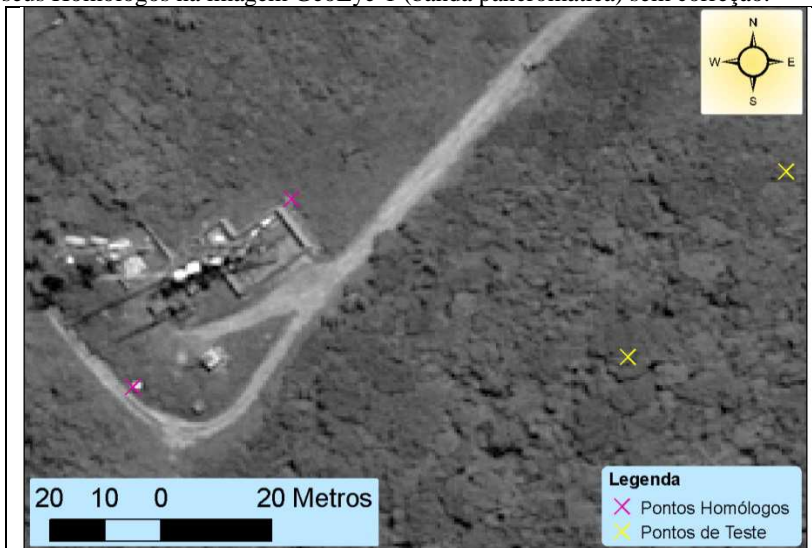
Figura 31: Diferenças entre coordenadas de dois Pontos de Teste (10 e 11) e seus Homólogos na imagem GeoEye-1 (banda pancromática) sem correção.
