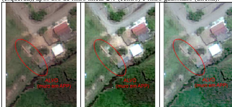
Figura 23: Comparação entre imagem após a fusão de bandas, sem uso de filtro (esquerda), após uso de filtro linear 2% (centro) e filtro gaussiano (direita).
