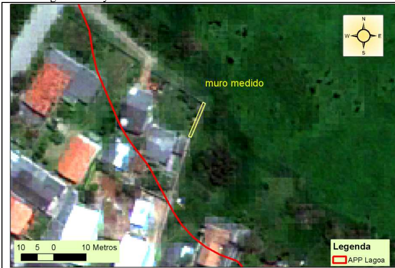
Figura 57: Detalhe do muro em APP da lagoa, medido a campo e remotamente, sobre imagem GeoEye-1 ortorretificada.
