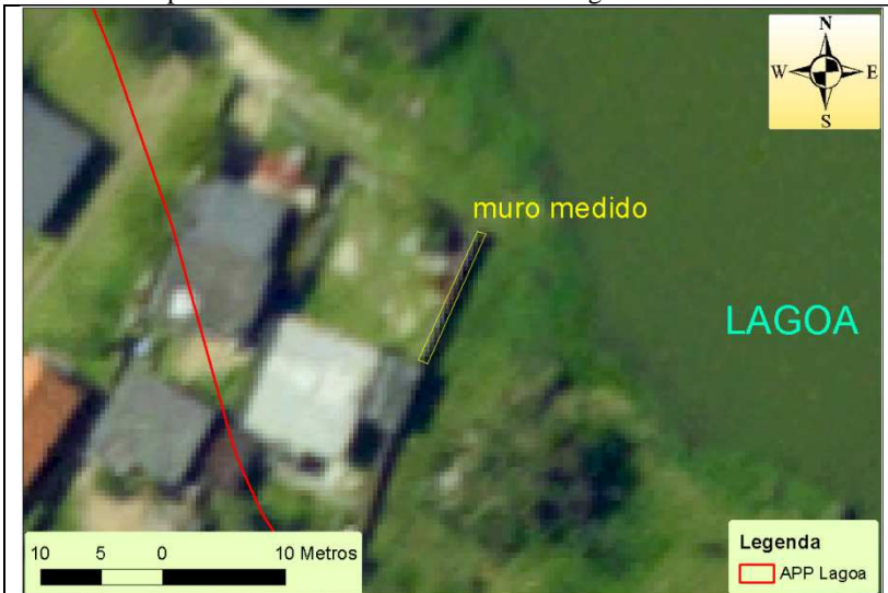
Figura 41: Detalhe do muro em APP da lagoa, medido a campo e remotamente, sobre ortofoto proveniente do levantamento aerofotogramétrico de 2010-2011.
