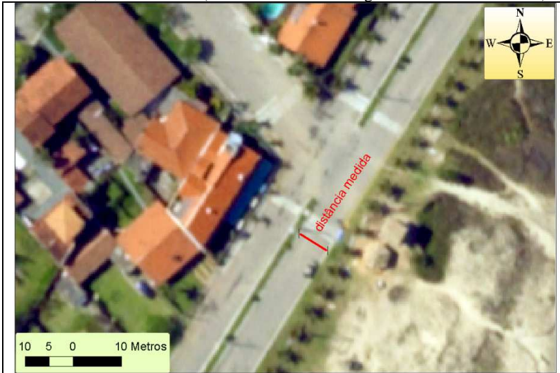
Figura 43: Detalhe da pista leste do loteamento, medida a campo e remotamente, sobre ortofoto(levantamento aerofotogramétrico de 2010-2011).
