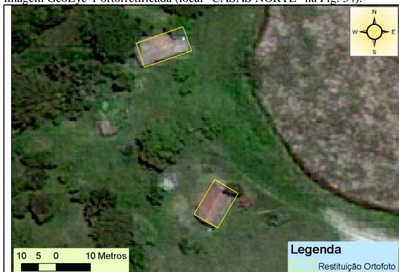
Figura 39: Comparação entre restituição parcial criada a partir da ortofoto e imagem GeoEye-1 ortorretificada (local “CASAS NORTE” na Fig. 34).
