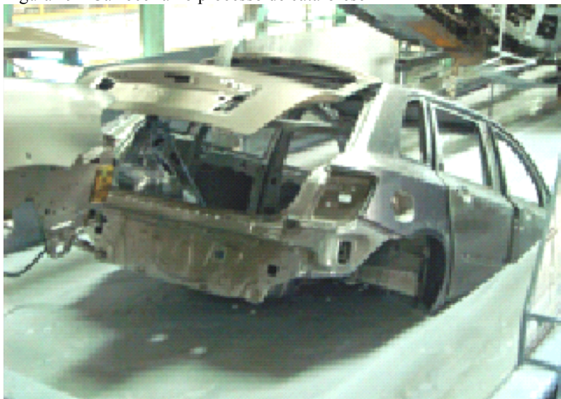
Figura 19 - Carroceria no processo de cataforese
