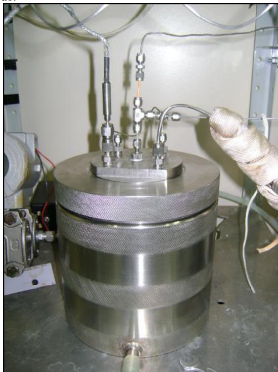
Figura 4.3 – Câmara de precipitação conectada a todas as linhas da unidade de coprecipitação.
