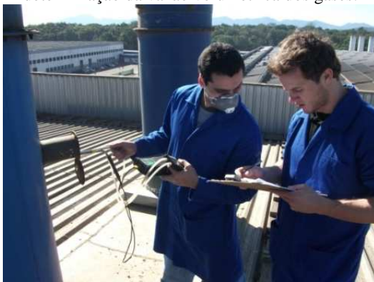
Figura 16 –Medições de temperatura e pressão em chaminé para determinação da vazão volumétrica dos gases.
