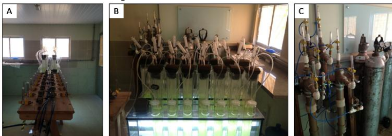
Figura 26 - (A) Mesa com rotômetros para controle da vazão na entrada das unidades experimentais; (B) Entrada e saída de ar das unidades experimentais; (C) Misturador de gases com rotômetros para controle de vazão do compressor de ar e do cilindro de \text{CO}_2 .
