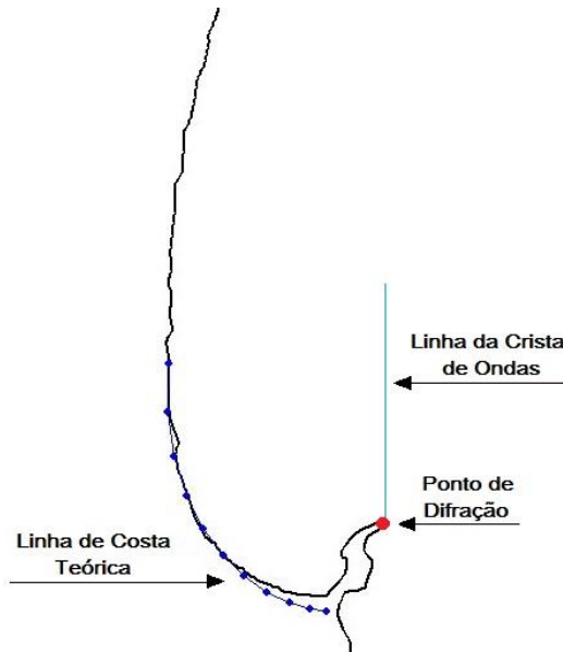
Figura 43 – Definição da Linha da Crista de Ondas e do Ponto de Difração. Resultado da Linha de Costa Teórica obtida através do software MEPPE 2.0
