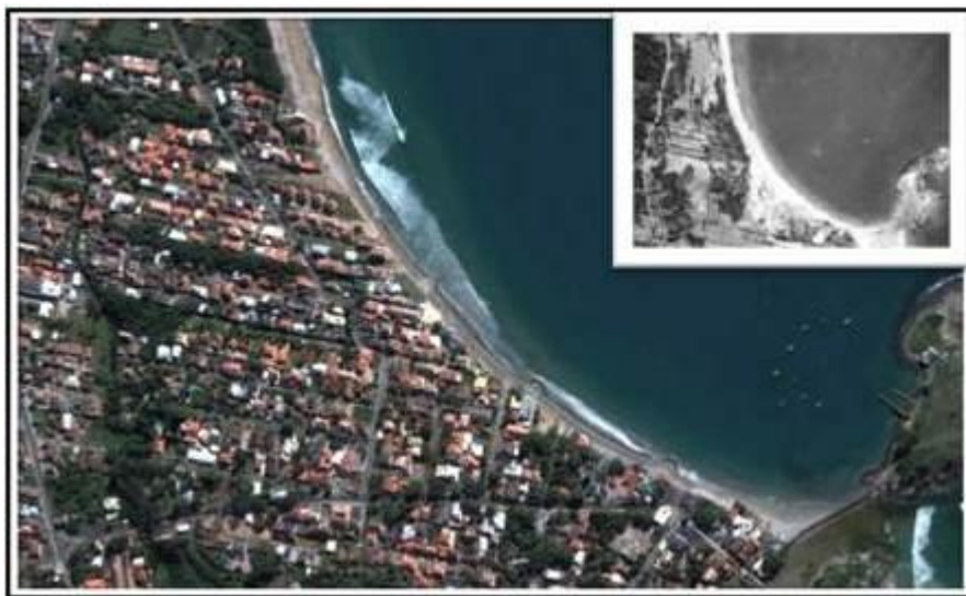
Figura 40 – Imagem aérea do setor sul da Praia da Armação (2011 e 1957 no detalhe), com visível supressão das dunas pela urbanização.
