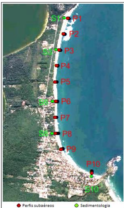
Figura 22 – Pontos de Levantamento Topográfico (pontos vermelhos) e de coleta de sedimentos (pontos verdes).
