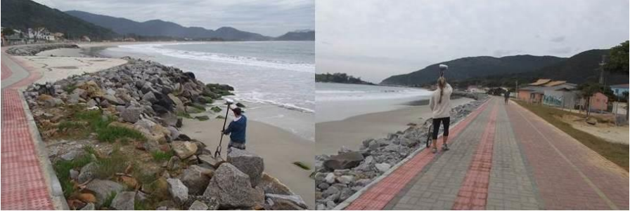
Figura 27 – Levantamento da forma e altimetria da obra de enrocamento
