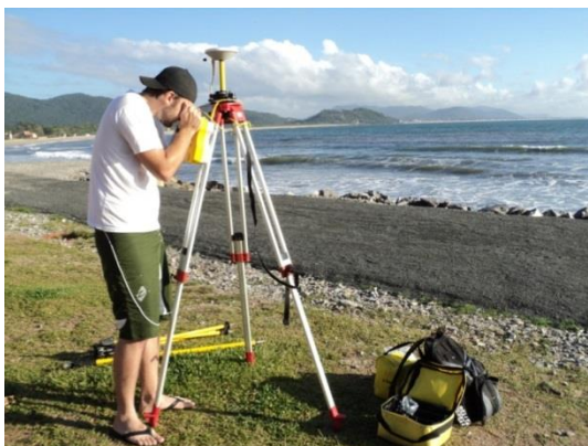
Figura 25 – Instalação da Base L1 do DGPS na Praia da Armação.
