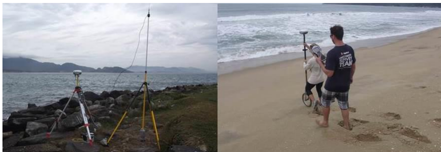
Figura 26 – Base instalada no marco do LOC na Ilha das Campanhas (à esquerda) e levantamento do perfil 3 (à direita)
