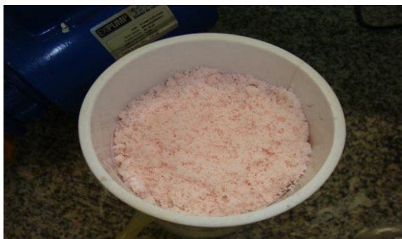
Figura 9 – Cristais de sulfato de manganês retidos no papel filtro.
