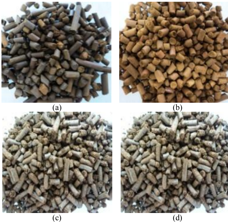
Figura 10: Imagens do óxido/hidróxido de ferro peletizado sem adição de ligantes e diferentes conteúdos de umidade inicial, utilizando a matriz de 4,0 mm. Umidade inicial: (a) 25 %; (b) 30 %; (c) 36 %; (d) 38 %.
