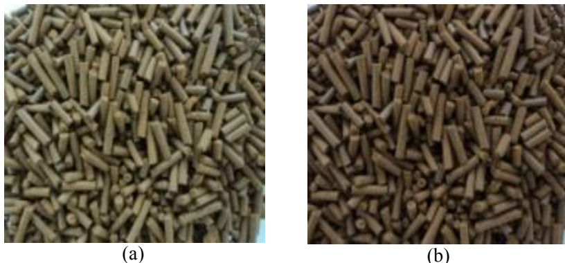
Figura 11: Imagens do óxido/hidróxido de ferro peletizado sem adição de ligantes e diferentes conteúdos de umidade ((a) 30 %; (b) 37 %) com a matriz de 2,0 mm.
