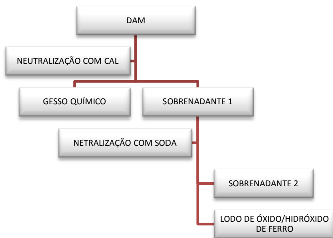
Figura 7: Fluxograma de obtenção da matéria-prima (lodo de óxido/hidróxido de ferro) utilizada na preparação dos pellets adsorventes.
