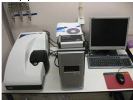
Figura 11: Equipamento zetasizer nano ZS.
