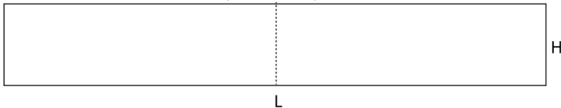
Figura 59. Domínio de Cálculo do Escoamento Cisalhante Vertical onde L=1,00m e H=0,15m .
