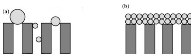
Figura 11 - Colmatação em membranas. a) bloqueio dos poros; b) formação da torta
