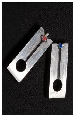
Figura 16: espécime fixado ao dispositivo de Geraldeli após a fratura
