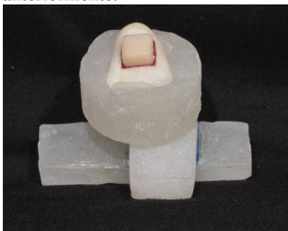
Figura 9: conjunto dente-resina acrílica em posição no dispositivo para cortes
