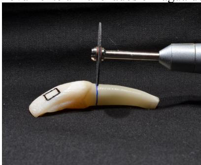
Figura 3: corte das raízes com disco de carborundum acoplado à peça reta
