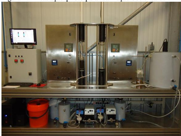
Figura 17. Instalação-piloto para realização dos ensaios em coluna de leito fixo.
