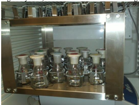
Figura 14. Conjunto de erlenmeyers sobre um agitador orbital (VWR advanced digital system) no interior de uma estufa refrigerada Lovibond.
