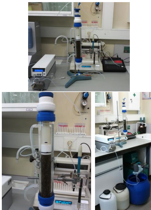
Figura 15. Instalação experimental para realização dos ensaios em coluna de leito fixo.
