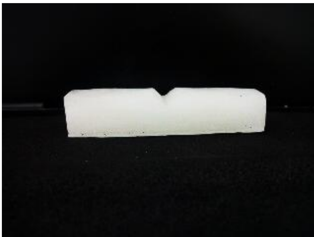
Figura 3.1 - Corpo de prova sem revestimento.
