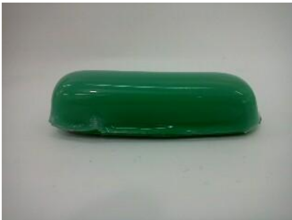
Figura 3.3 - Corpo de prova revestido com placa de EVA de 5 mm.
