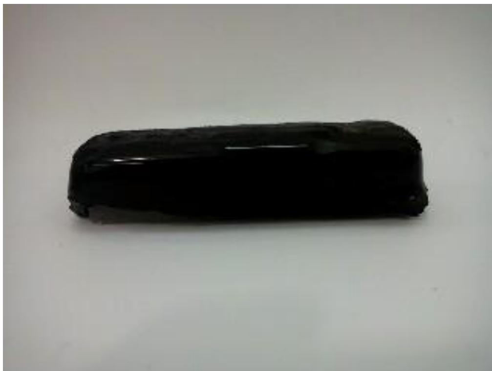
Figura 3.2 - Corpo de prova revestido com placa de EVA de 3mm.
