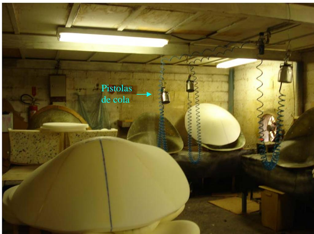
**Figura 26:** Visão geral do espaço de colagem da espuma.
