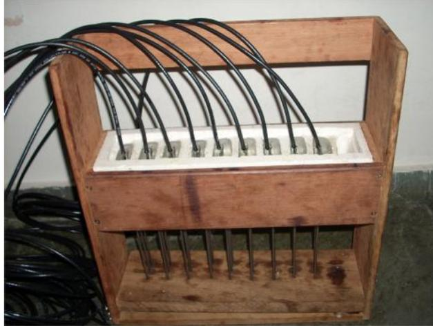
Figura 2 - Sondas acomodadas no molde de silicone na estrutura de madeira para aplicação da resina
